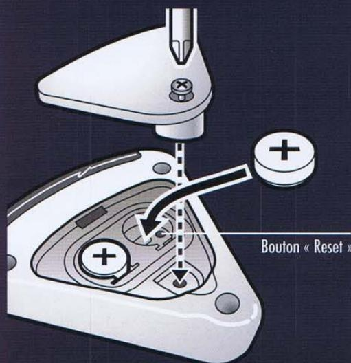
Fonctionne avec 2 piles LR44 par télécommande (incluses).
