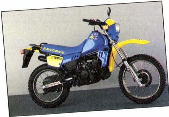
**1<sup>er</sup> prix :** une moto Peugeot trial X 125 LC (pour les connaisseurs : mono-cylindre 2 temps à refroidissement liquide, boîte 6 vitesses).
