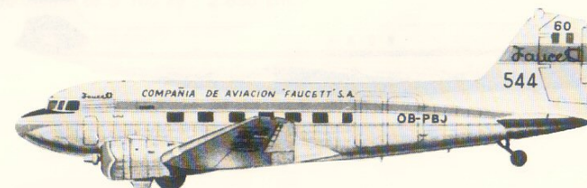
Douglas DC-3 de la Compagnia de Aviacion Faucett S.A. Moteurs : deux moteurs à pistons en étoile Pratt & Whitney R-1830-92 de 1 200 CV et 14 cylindres. Envergure : 28,96 m. Longueur : 19,52 m. Surface alaire : 91,70 m 2 . Poids maximum au décollage : 11 430 kg. Vitesse de croisière caractéristique : 290 km/h à 3 000 m. Plafond opérationnel : 7 300 m. Rayon d'action avec charge marchande maximum de 2 270 kg : 1 060 km.
