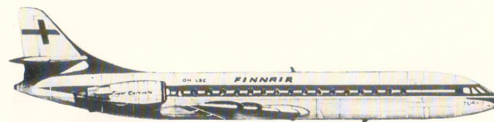
Aérospatiale Caravelle Super B Turku d'Aero O/Y (Finnair), v. 1966. Moteurs : deux turboréacteurs double-flux Pratt & Whitney JT8D-1 de 6 350 kg. Envergure : 34,30 m. Longueur : 33,01 m. Surface alaire : 146,70 m 2 . Poids maximum au décollage : 52 000 kg. Vitesse maximum de croisière : 825 km/h à 7 260 m. Plafond opérationnel : 10 000 m. Rayon d'action avec charge marchande maximum de 9 100 kg : 2 650 km.
