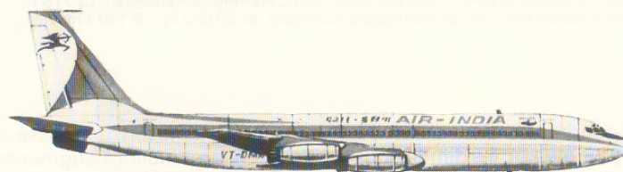
Boeing 707-437 Kanchenjunga d'Air-India, v. 1962. Moteurs : quatre turboréacteurs double-flux Rolls-Royce Conway Mk 508 de 7 945 kg. Envergure : 43,41 m. Longueur : 46,61 m. Surface alaire : 268,68 m 2 . Poids maximum au décollage : 141 520 kg. Vitesse maximum de croisière : 955 km/h à 7 620 m. Plafond opérationnel : 12 800 m. Rayon d'action avec charge marchande maximum de 25 850 kg : 7 830 km.
